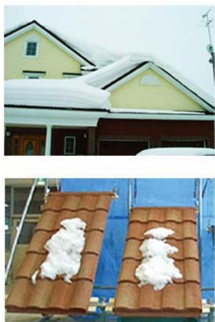
表面にコーティングされている自然石粒の強い摩擦抵抗力が雪止め効果を発揮します。谷部までしっかりと屋根材が入る納まりにすることによって、厄介だった落雪に悩まされる心配が大幅に軽減されます。また、自然石粒特有の「吸熱効果」が、止めた雪をじわじわ溶かしていきます。
